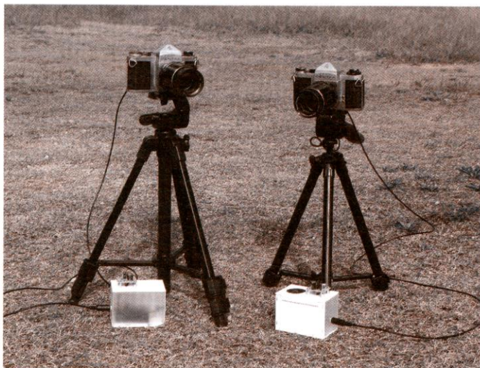
〈写真 10〉ビームを安定的にとらえるため、三脚で固定
