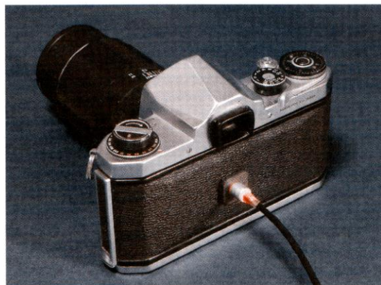
《写真9》カメラの裏蓋に穴をあけてセンサーを挿し、エポキシ接着剤で固定した
