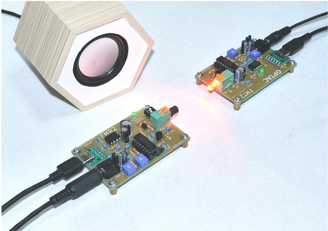
副搬送波の周波数調整については、双方基板の RV2 のポジションを 2 時位置にしておけば特に問題なく使用できますが、最良のポジションを求める場合は FMR2 側で微調整してください。
