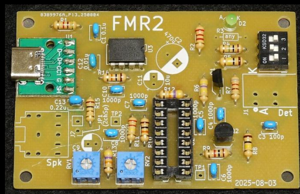
USB 電源のサブ基板はメイン基板に装着済みです
