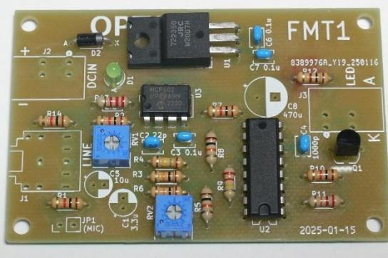
※ 写真では IC が基板直付けになっていますが、キットに IC ソケットが付属している場合にはそれを基板にハンダ付けしてください。
